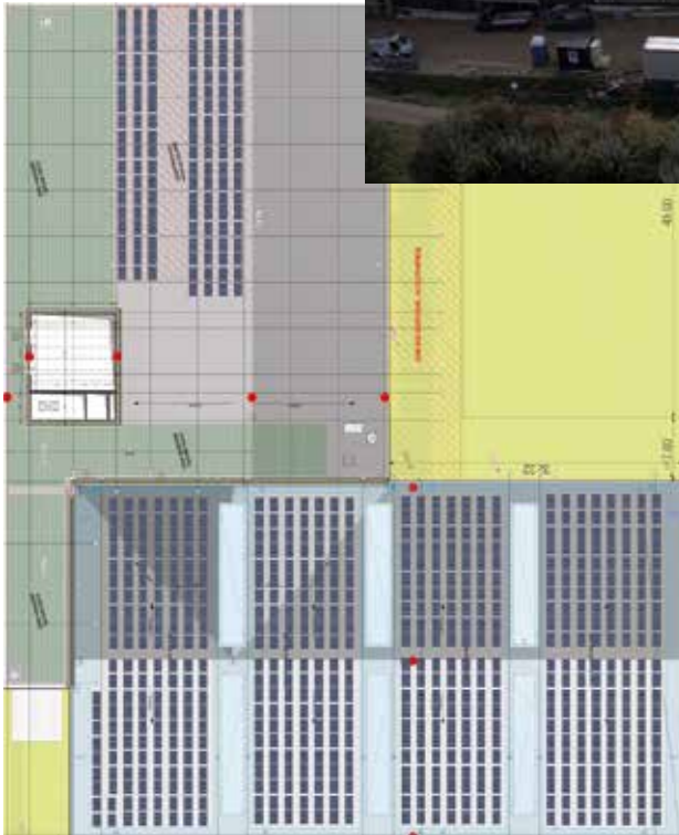
Anordnung der Photovoltaikmodul. Disposition des modules photovoltaïques.
